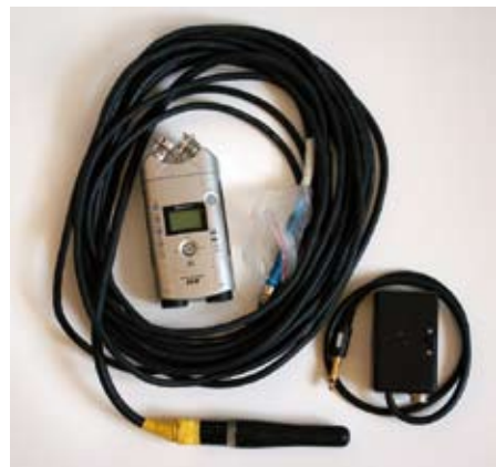
Набор для записи звуков китообразных: гидрофон, блок фантомного питания, флэш-рекордер.
