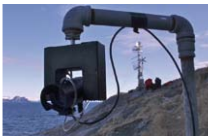
Дистанционно управляемая видеокамера, установленная на лежбище сивучей (о. Чизвел, Аляска). На заднем плане видны передающая телесистема и ветрогенератор.
